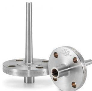
Os Poços Termométricos Flangeados são utilizados quando as condições de pressão, alta velocidade e fluido corrosivo assim o requerem. Servem para isolar e proteger o instrumento de temperatura e permitem a sua remoção sem interromper o processo. É a solução perfeita para proteger o processo e aumentar a vida útil do instrumento.
